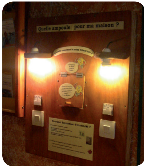
Panneau pédagogique au Loubatas (Bouches du Rhône) permettant de comparer la consommation d'une ampoule à incandescence et d'une ampoule fluocompacte.
