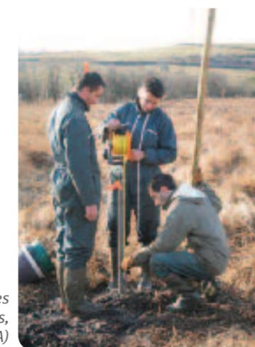
Installation des piézomètres pour les suivis hydrologiques, en 2007 (photo SMPNRVA)
