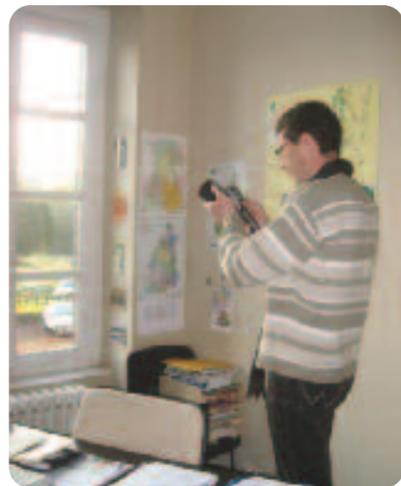
La caméra thermique a révélé des points faibles au niveau des fenêtres du château de Montlosier - (photo SMPNRVA)
